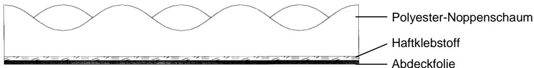
emfa® 1135 ist ein feinporiger PUR-Noppenschaum mit offener luftdurchlässiger Oberflächenstruktur. Er ist selbstklebend ausgerüstet mit einem hochwertigen Klebstoffsyste auf Acrylatbasis.
